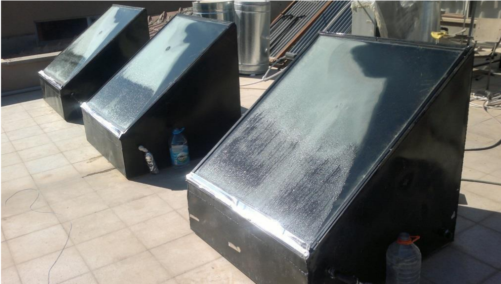
Şekil 2. Deneylerde Kullanılan Güneş Enerjili Havuz Tipi Damıtıcılar
